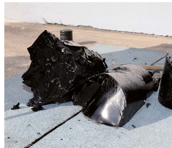
Oxidationsbitumen kommt momentan häufig in Heißbitumen-Klebmassen, die für das Gießverfahren verwendet werden vor
